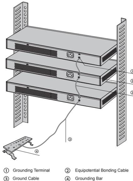
Figure 3-3 Equipotential Bonding
