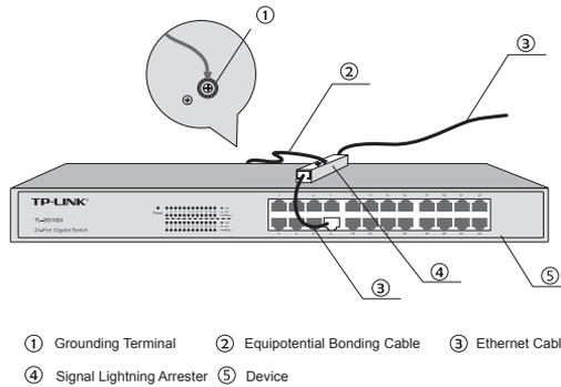
Figure 3-4 Equipotential Bonding
