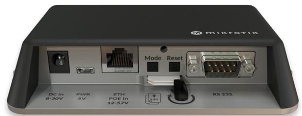
Dispone de un puerto Ethernet para tus dispositivos con cable y una radio inalámbrica clásica de 2,4 GHz. El puerto serie RS232 te permite acceder a la consola para realizar depuraciones.
