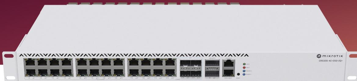
*Tiene 20 puertos 2,5 Gigabit Ethernet, 4 puertos COMBINADOS que se pueden usar como 4 puertos adicionales de 2,5 Gigabit Ethernet O como interfaces 10G SFP+, y además de todo eso, cuenta con 2 jaulas QSFP+ de 40 Gigabit para conectividad de fibra ultrarrápida. ¡Práctico y listo para el futuro!*
