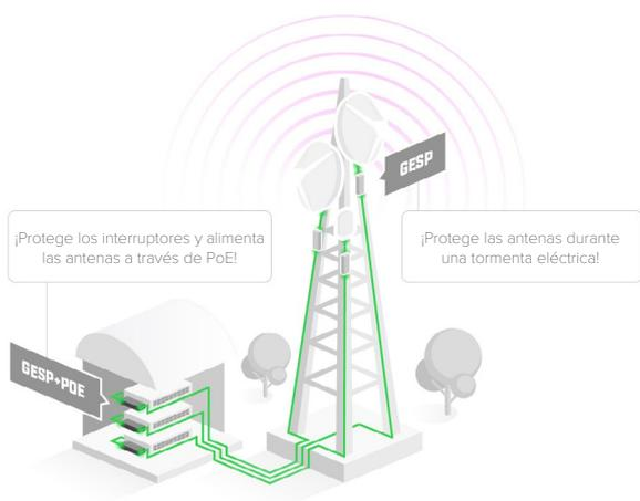
Aquí va un caso típico de uso. Tienes un mástil con algunas antenas. Y algunos interruptores en el suelo. Pon el protector de sobretensiones GESP allí. Viene sellado dentro de una nueva y mejorada carcasa resistente a la intemperie IP67. Tus antenas están ahora a salvo durante una tormenta eléctrica. Ahora añade el inyector GESP+POE-IN debajo del mástil, para proteger los interruptores y alimentar las antenas.
