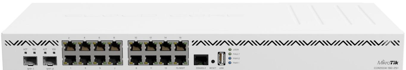
El nuevo enrutador tiene 18 puertos cableados, incluidos 16 puertos Gigabit Ethernet y dos jaulas SFP+ de 10 G. También tiene un puerto de consola USB y RJ-45 de tamaño completo en el panel frontal.
